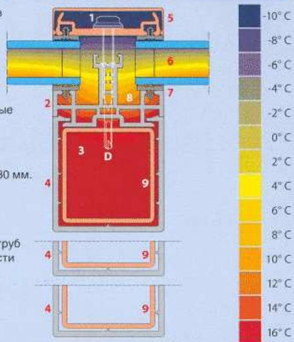
Превосходные теплозащитные свойства обеспечивают прохождение 10-градусной линии изотермы внутри конструкции.
