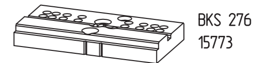
Шаблон для крепления импоста H576/D и крепления импоста через VTA
